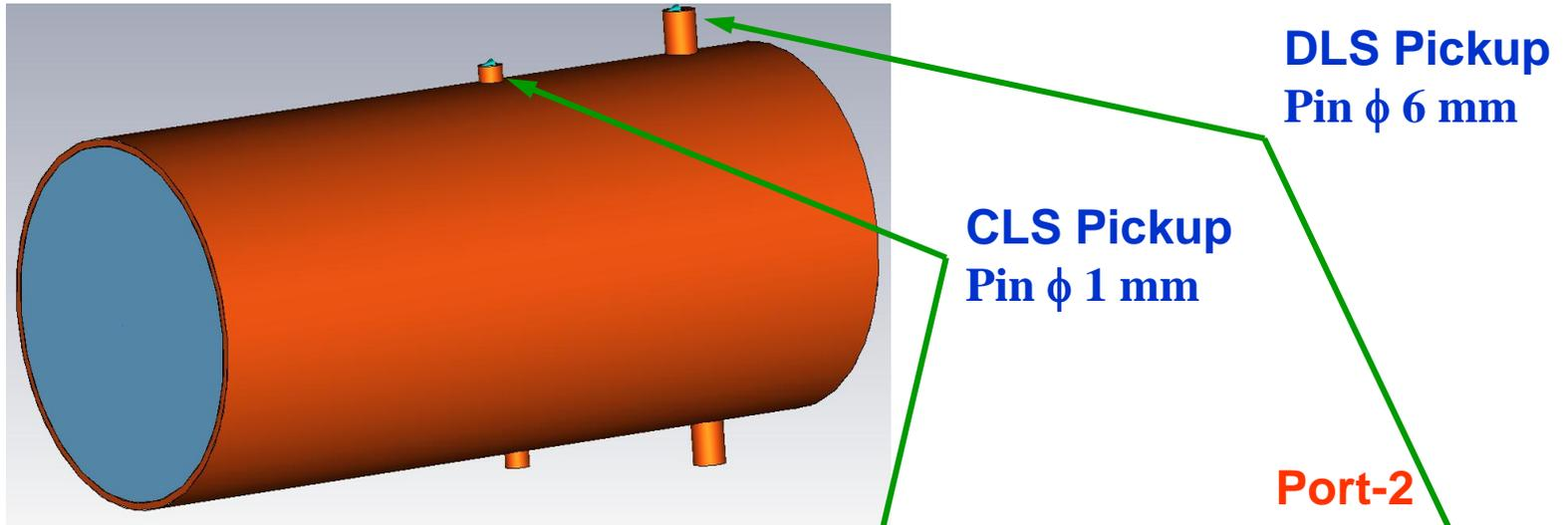
$\phi$ 240 mm beam pipe **Port-1**
